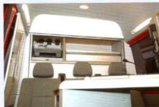
Die Rückwand beherbergt das Fax-Gerät und Staufächer nach innen. Auf der Rückseite befinden sich Kunststoffbehälter für weiteres Material (siehe rechts)
