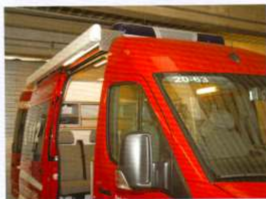
Eigens für die Markise wurde eine Halterung für das Crafter-Hochdach gefertigt.
